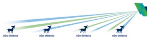
Exemplo do duplo circuito de detecção (circuito 1 a azul e 2 a verde).
