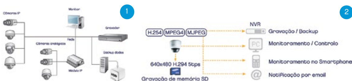
1. Exemplo de esquema de ligação em rede de câmaras analógicas e IP. 2. Diferentes protocolos de compressão de imagem e sua utilização;
